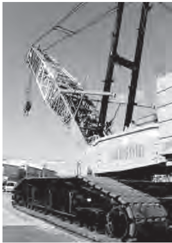
ブームを組み合わせた巨大なクローラークレーン
